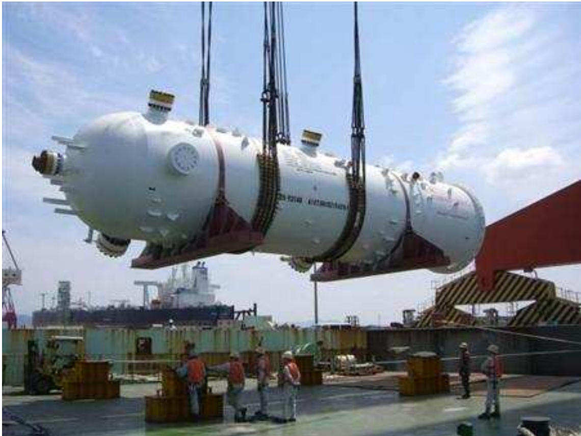
日立造船が製造する圧力容器の1つ、クロムモリブデン鋼製高温高圧リアクター。
